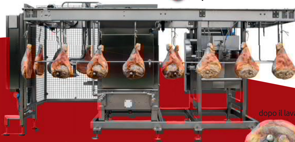
LLS143 Nuovo gruppo di lavaggio per prosciutto crudo COSTITUITO DA UNA SPAZZOLATRICE A SECCO DI NUOVA CONCEZIONE E DA UNA LAVAPROSCIUTTI DI GRANDE EFFICIENZA
